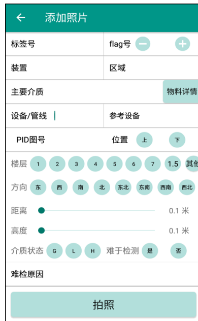
图 3.2.4-1 现场建档时手操器界面示例
